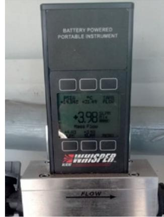
Medidor de masa de baja presión.
