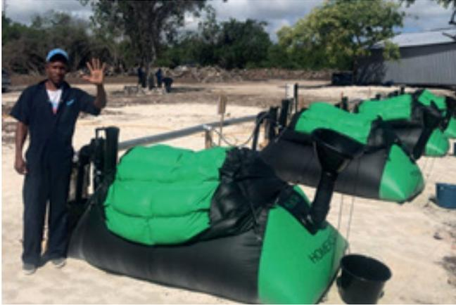
Figura 4: sistema biodigester compacto Homebiogas 2.0.
