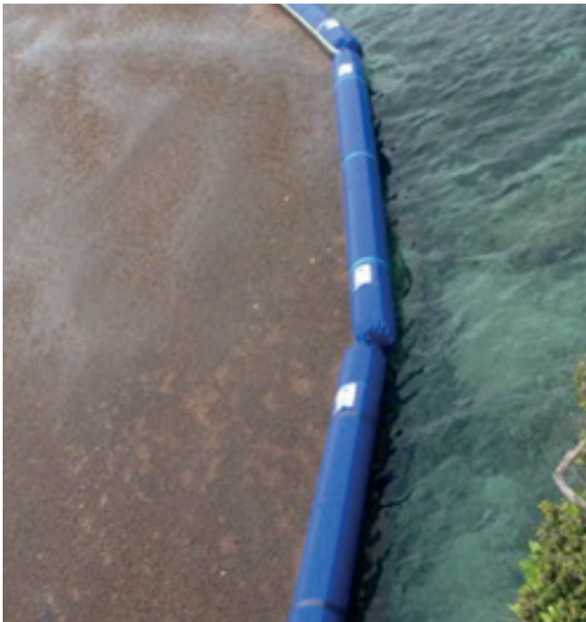
Figura 3. Barreras de contención. Fuente: AlgeaNova.
