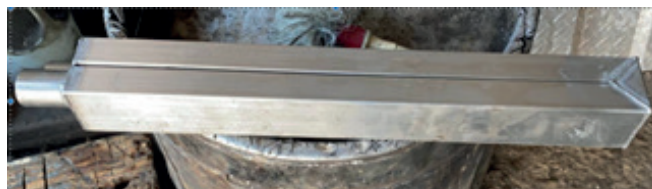
Figura 13: intercambiador de calor. Fuente: Unapec.
