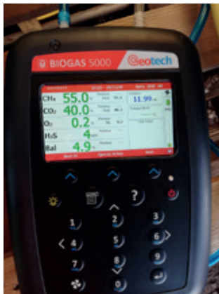
Analizador de biogás Geotech 5000, Aparato de adquisición de datos. Mide CH 4 , CO 2 y O 2 .
