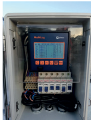
Analizador de biogás Geotech 5000, Aparato de adquisición de datos. Mide CH 4 , CO 2 y O 2 .
