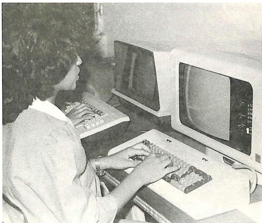
Este Centro de Información consta de un sistema 34 IBM con capacidad de ejecución de 256 kb (256,000 caracteres) y una capacidad para archivo de 257 mb (257,000,000 caracteres), 13 terminales y tres impresoras (una lineal con capacidad de 650 líneas de 132 caracteres por minuto y 2 matriciales con capacidad para 120 caracteres por segundo).
