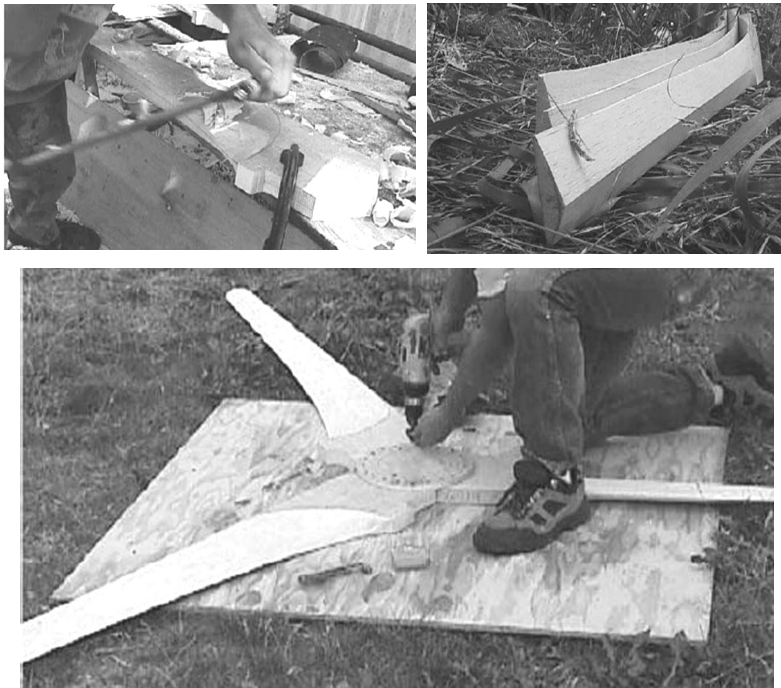
Detalles sobre la fabricación de las Hélices o Aspas del tripala Wilcapec4.
